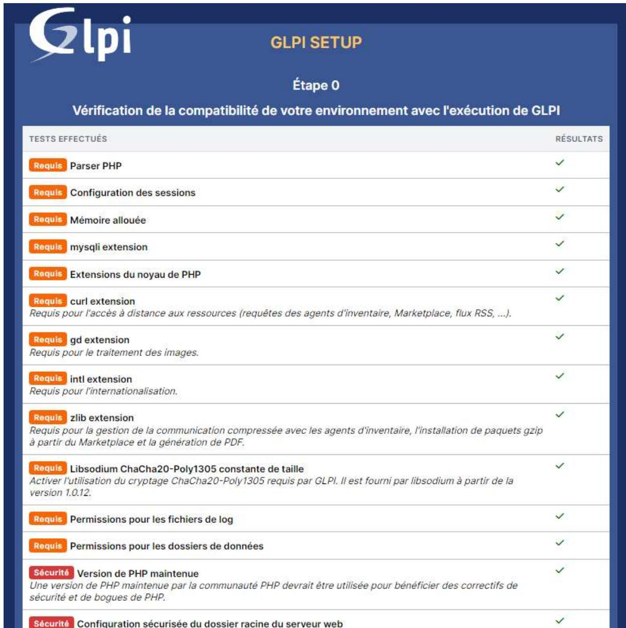
The screenshot shows the GLPI Setup interface at 'Étape 0' (Step 0), titled 'Vérification de la compatibilité de votre environnement avec l'exécution de GLPI'. It displays a table of tests performed, all of which passed successfully, indicated by green checkmarks in the 'RÉSULTATS' column.
